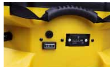
Ovládací panel CDX 20, počítadlo motohodin
